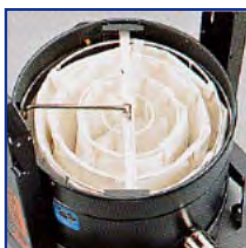
Filter: Großer Sackfilter für perfekte Staubabscheidung
